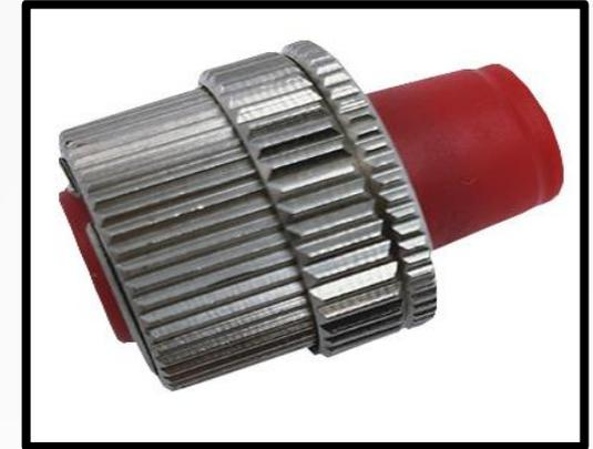
Изменение аттенюации может происходить из-за того, что в результате нагрева данного аттенюатора в случае децентрировки будет происходить диафрагмирование за счет изменения оптической апертуры оптических волокон.
