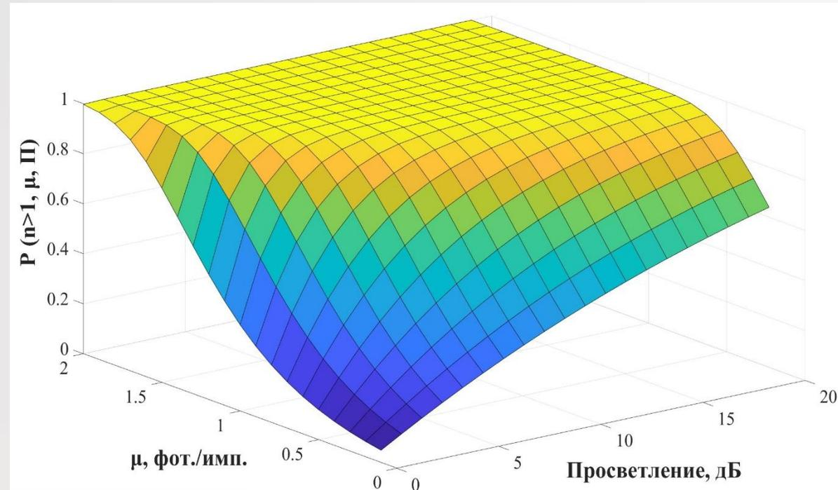
Было выполнено моделирование графика, который иллюстрирует зависимость вероятности появления двух фотонов в импульсе от просветления ( $\Pi$ ) и среднего числа фотонов ( $\mu$ ).
